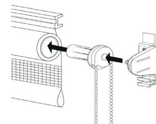
Надеваем на цепочный механизм (8) ограничительное кольцо (4) и вставляем в трубу рулонной шторы (6). Соединяем кронштейн (1) с цепочным механизмом (8).
