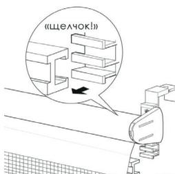
Соединяем каркасный профиль (5)
