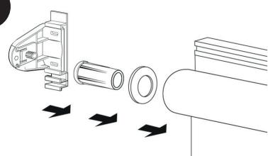
Собираем штору целиком для точной разметки отверстий на створке / стене / потолке. Надеваем на втулку (3) ограничительное кольцо (4) и вставляем в трубу рулонной шторы (6). Соединяем кронштейн (1) с цепочным механизмом (8).
