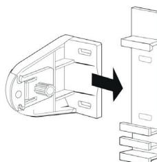
Закрепляем кронштейны (1) на фиксаторы (2).
