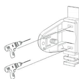
Сверлим в кронштейнах (1) с фиксаторами (2) отверстия диаметром 3-6 мм.
