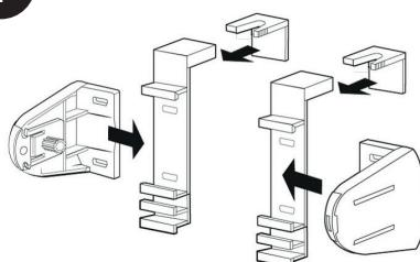
Защелкиваем на одно деление элементы фиксаторов (2).
