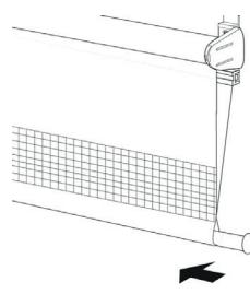
Помещаем утяжелитель (7) в нижний «карман» полотна шторы.
