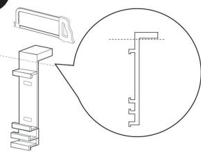
Удаляем верхнюю часть фиксатора (2) при помощи ножовки или кусачек.
