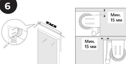
Делаем точную разметку на створке / стене / потолке при помощи пузырькового уровня.
