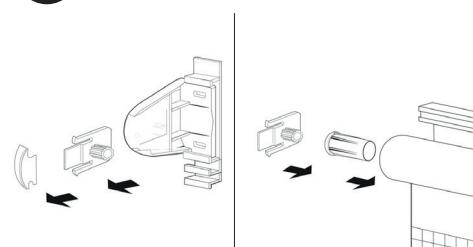
Разбираем один из кронштейнов (1). Соединяем элемент разобранного кронштейна (1) с втулкой (3).
