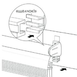
Соединяем каркасный профиль (5) с фиксатором (2) до щелчка.
